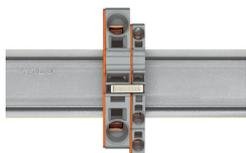
Lors du pontage avec des contacts de pontage réducteur il faut toujours prévoir une plaque d'extrémité entre les bornes à ponter.
