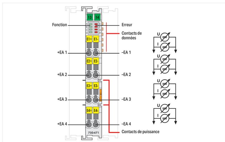
La borne d'entrées analogiques traite 4 signaux Tension ou Courant en différentiel.
