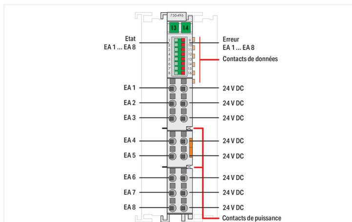
La borne d'entrées analogiques traite des signaux sur une plage de courant standardisée de 0 ... 20 mA, 4 ... 20 mA ainsi que 3,6 ... 21 mA (Namur NE43).
