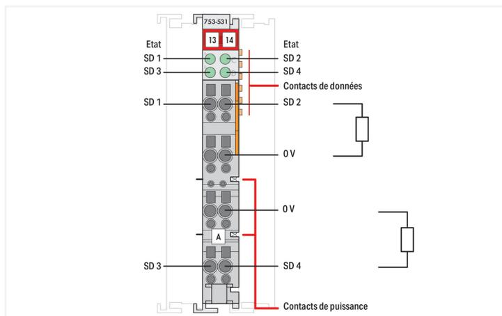
L'automate programmable transmet ses signaux de commande aux actionneurs connectés par l'intermédiaire des bornes de sorties digitales. La borne dispose de quatre canaux de sorties et permet de raccorder directement quatre actionneurs de 2 fils, car elle dispose de quatre points de raccordement 0 V.
