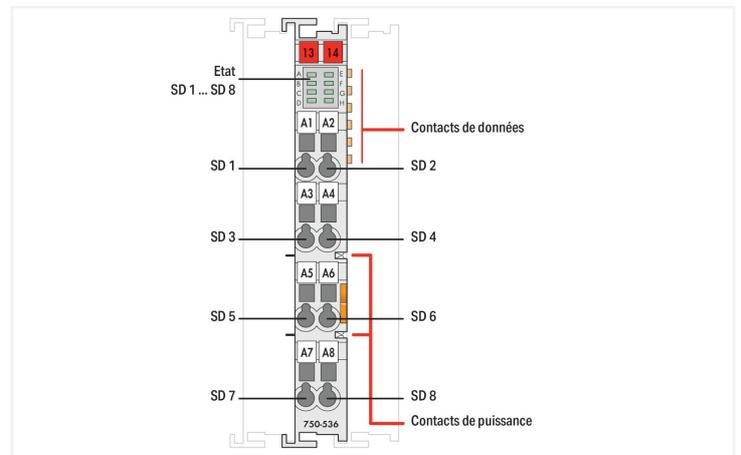
Cette borne de sorties digitales (T.O.R.) de seulement 12 mm de largeur dispose de 8 canaux. L'automate programmable transmet ses signaux de commande aux actionneurs connectés par l'intermédiaire des bornes de sorties digitales. Toutes les sorties sont protégées contre les courts-circuits. La séparation galvanique bus de terrain/bornes est assurée par des optocoupleurs.
