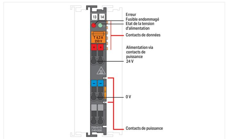
La borne d'alimentation alimente les diverses bornes de bus de terrain par les contacts de puissance.
