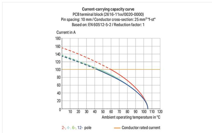
Borne pour circuits imprimés série 2616 avec introduction du conducteur vers la platine de 0°
