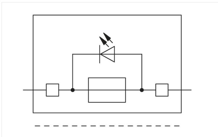
Borne à fusible série 2202 avec Push-in CAGE CLAMP®
