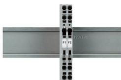
Des bornes à fusibles ou bornes sectionnables d'une largeur de 6,2 mm peuvent être assemblées directement les unes aux autres. En fin de montage ou s'il n'y a pas de borne à fusible adjacente, il faut utiliser une plaque intermédiaire ou d'extrémité.
