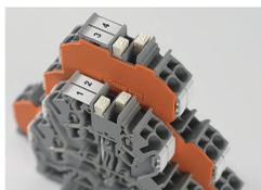
Le contact de pontage vertical pour la gamme de bornes sur rail TOPJOB®S relie deux ou trois niveaux entre eux en bornes à deux/trois étages. Puisqu'il s'agit d'un contact de pontage vertical à deux étages (2002-492) ou d'un contact de pontage vertical à trois étages (2002-493), un repérage visible « 2 » et « 3 » signale le nombre d'étages pontés.
