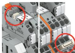
Le profil identique des bornes TOPJOB®S permet le pontage de l'étage supérieur avec des bornes à deux étages et sur l'étage inférieur avec des bornes à trois étages.
