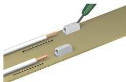
Outil de manipulation pour raccorder les conducteurs souples et déconnecter tous les conducteurs. La connexion des câbles rigides se réalise par insertion directe.
