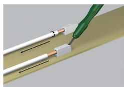
Déconnecter les conducteurs rigides avec l'outil de manipulation ou en tournant et en tirant
