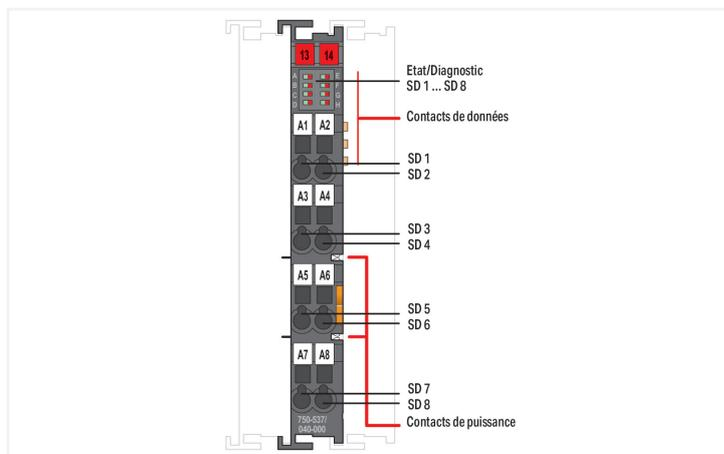
L'automate programmable transmet ses signaux de commande aux actionneurs connectés par l'intermédiaire des bornes de sorties digitales. Toutes les sorties sont protégées contre les courts-circuits. La borne reconnaît les surcharges, courts-circuits et ruptures de fil. L'état et le diagnostic sont indiqués par des diodes LED. La borne dispose de 8 sorties et permet de raccorder directement 8 actionneurs. La séparation galvanique bus de terrain/bornes est assurée par des optocoupleurs.
