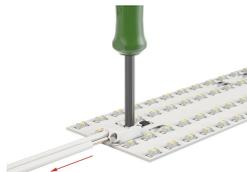
Connexion des conducteurs souples et déconnexion des conducteurs – avec légère pression sur le poussoir, par ex. avec outil de manipulation 206-860.
