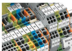
Les bornes X-COM®S-SYSTEM peuvent être pontées avec les bornes TOPJOB® S avec le même système de pontage. Un raccordement aux bornes TOPJOB® S est également possible par plaque d'extrémité. Les bornes des séries 2020 et 2022 sont combinables. Les canaux de pontage des deux séries se trouvent sur le même niveau.
