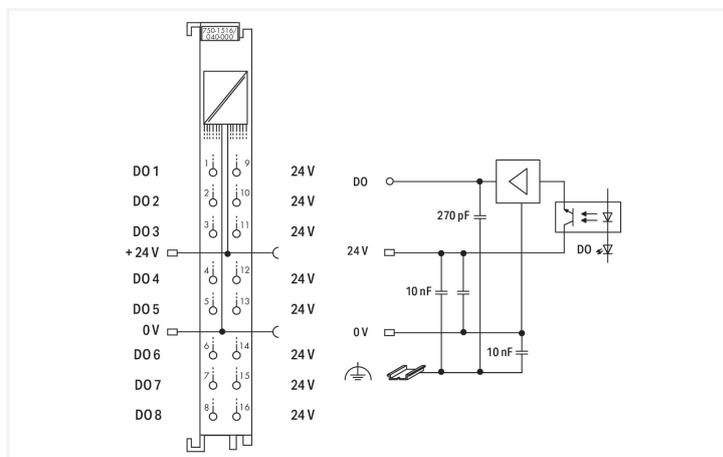
Cette borne d'entrées digitales (T.O.R.) de seulement 12 mm de large dispose de 8 canaux avec technique de raccordement pour 2 conducteurs. Elle transmet des signaux de commande à partir des dispositifs d'automatisation aux actionneurs connectés (p.ex. électrovannes, contacteurs, capteurs, relais ou autres charges électriques).
