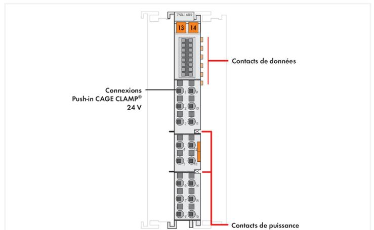
Cette borne de distribution de polarités, en combinaison avec les bornes d'entrées à 16 canaux réf. 750-1405 et 750-1406 (également pour bornes d'entrées à 8 canaux avec raccordement à 1 fil), met à disposition 16 points de connexion 24 V.
