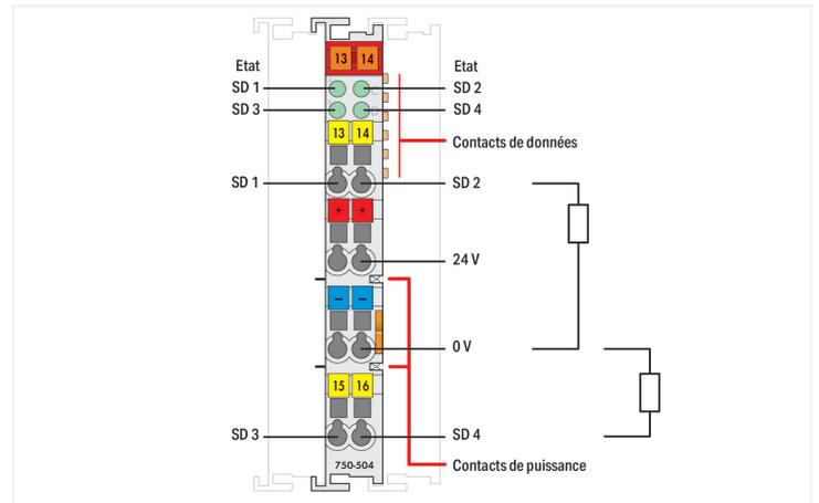
L'automate programmable transmet ses signaux de commande aux actionneurs connectés par l'intermédiaire des bornes de sorties digitales. Toutes les sorties sont protégées contre les courts-circuits. La séparation galvanique bus de terrain/bornes est assurée par des optocoupleurs.
