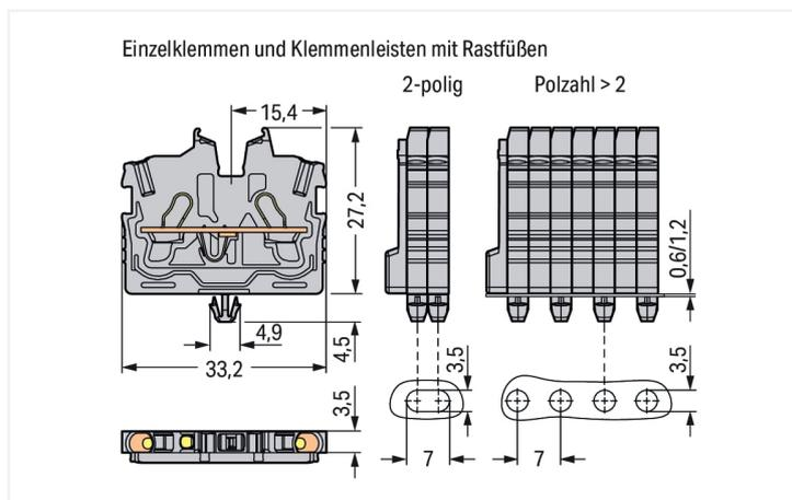
Borne de passage série 2050 avec Push-in CAGE CLAMP®
