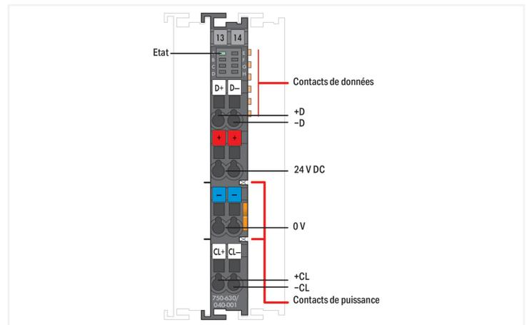
La borne est l'interface pour la connexion directe d'un codeur SSI.
