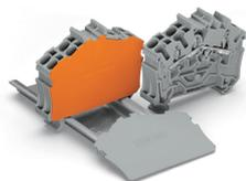
Dans le cas du passage d'une borne pour 3 conducteurs à une borne pour 4 conducteurs à une borne pour 4 conducteurs (forme coudée), et vice versa, il faut monter une plaque d'extrémité.
