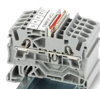
Les repères rouges du pont intercalable sont à diriger vers l'intérieur. Placer le pont intercalable et le pousser jusqu'en butée.
