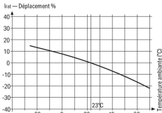
Indications pour l'utilisation des bornes à fusibles pour cartouches G Les courants nominaux des fusibles sont définis de manière différente dans les normes internationales. En fonction des différentes définitions de courant nominal, l'intensité continue du courant nominal recommandée est d'un maximum de 80% du courant des fusibles selon DIN 72581 partie 3 (pour une température ambiante de 23°C). En ce qui concerne la sécurité des produits dans les applications et la durée de service/la fiabilité des fusibles, il est important de faire le bon choix. En effet, les fusibles ne peuvent remplir correctement leur fonction d'élément de protection (destiné à l'interruption) que s'ils sont correctement sélectionnés et utilisés selon les prescriptions techniques mentionnées dans leur fiche technique, et dans le respect des précautions de sécurité (protection des personnes et des appareils).
