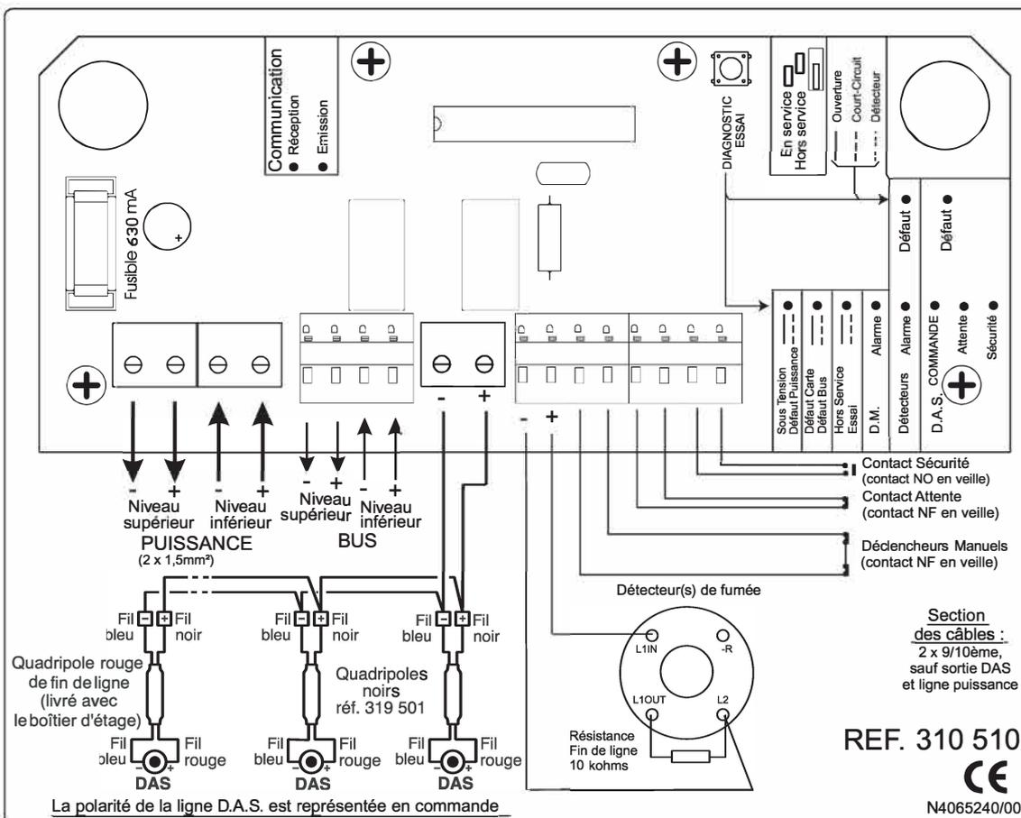
**Raccordements de trappes de désenfumage sur module B.E.A. (via module M.D.R.)**
