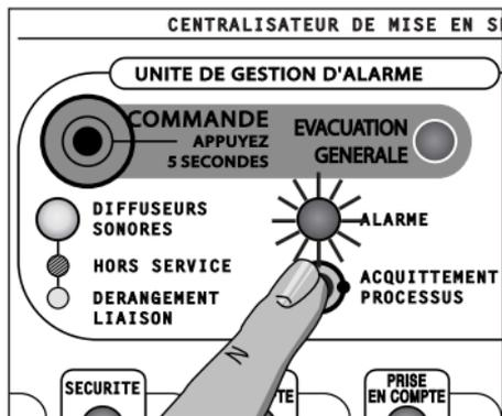
Après avoir vérifié l'origine de l'incident, l'acquittement manuel de l'alarme se fait en passant au niveau 2 avec la clé et en appuyant sur la touche ACQUITTEMENT PROCESSUS.
