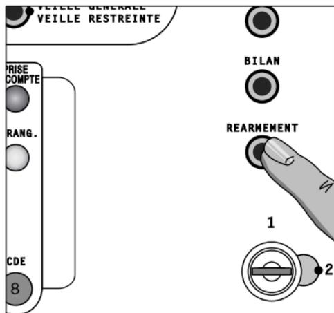
Procéder au réarmement du CMSI en passant au niveau 2 avec la clé et en appuyant sur la touche "REARMEMENT" (si la ligne a été mise en sécurité depuis au moins 2 minutes).
