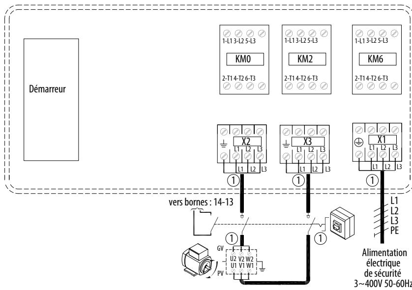
(1) câble protégé au feu - Nota : seuls les raccordements à effectuer sont indiqués sur ce schéma. Les autres câblages réalisés d'usine ne sont pas représentés et ne doivent en aucun cas être modifiés.
