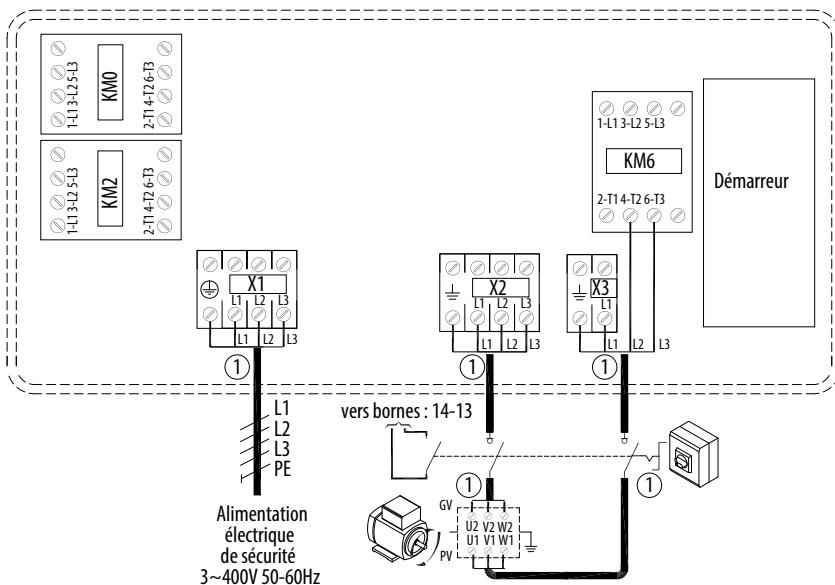
① câble protégé au feu - Nota : seuls les raccordements à effectuer sont indiqués sur ce schéma. Les autres câblages réalisés d'usine ne sont pas représentés et ne doivent en aucun cas être modifiés.
