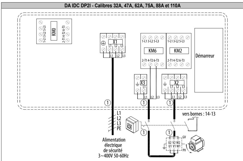
(1) câble protégé au feu - Nota : seuls les raccordements à effectuer sont indiqués sur ce schéma. Les autres câblages réalisés d'usine ne sont pas représentés et ne doivent en aucun cas être modifiés.
