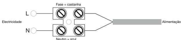
Nos quartos húmidos , quartos de banho ou cozinhas, o terminal deve instalar-se pelo menos a 25 centímetros do solo. A ligação pode ser fixada apenas em redes de cabo que estão equipadas para separar o contacto omipolar com uma abertura de 3mm em todos os pólos.
