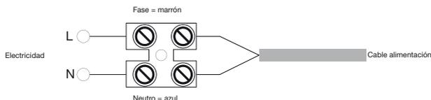
En los cuartos húmedos, cuartos de baño o cocinas, el terminal se debe instalar por lo menos a 25 centímetros del suelo. La conexión fija solamente podrá efectuarse en redes de cables que estén equipadas con un dispositivo de separación omnipolar con una apertura de contactos de 3 mm como mínimo en todos los polos.
