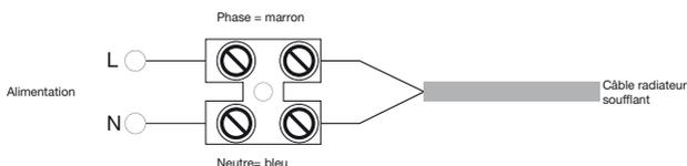
Dans les pièces humides, salles de bains ou cuisines, ce boîtier de raccordement doit être installé à au moins 25 cm du sol. Pour le raccordement, la ligne électrique devra prévoir un interrupteur omnipolaire ayant une ouverture entre contacts d'au moins 3 mm, bien dimensionné par rapport à la charge et conforme aux normes en vigueur.
