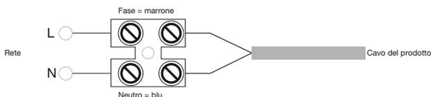
In locali umidi, nei bagni o nelle cucine, il morsetto di collegamento deve essere installato ad almeno 25cm dal pavimento. Il collegamento elettrico con la rete deve inoltre prevedere l'utilizzo di un interruttore bipolare con una distanza minima di apertura fra i contatti di almeno 3mm.
