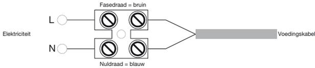
In vochtige kamers, badkamers of keukens, dient de terminal ten minste op 25 centimeter hoogte van de grond geïnstalleerd te worden. De vaste aansluiting is slechts mogelijk op kabelnetwerken voorzien van een omnipolair scheidingsmechaniek met een contactopening van minimaal 3 mm bij alle polen.
