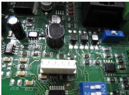
4. Aligned le composant électronique TIMER RTC ECOWATT avec les pattes du connecteur J4
