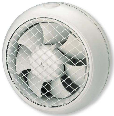
Gamme d'aérateurs hélicoïdes conçus pour le renouvellement d'air dans les locaux domestiques ou tertiaire. Virole en plastique injecté. Grille de protection à l'aspiration et soufflage. Volet de fermeture au soufflage. Hélice profilée en plastique injecté. Tous les aérateurs sont de classe II, IPX4.
