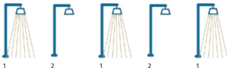
À l'heure définie, coupure du second canal afin d'économiser de l'énergie et de maintenir un éclairage de base.
