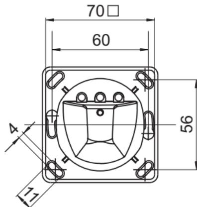
Dimensions boîtier apparent pour PresenceLight 360x-KNX,
