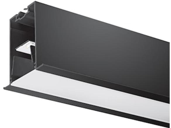
Luminaire LED linéaire, pour installation encastrée. Module avec bords pour la réalisation de lignes continues. Longueur 2400mm. Finition noire. Diffuseur opale. Eclairage direct. Dimmable DALI. Flux 4800lm, efficacité lumineuse 133lm/W. Température de couleur : blanc neutre (4000K). IRC > 80 / SDCM < 3. Groupe de risque photobiologique GR0. IP20 / IK03. Durée de vie 92 500 heures (L80). Garantie 5 ans.
