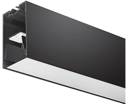
Luminaire LED linéaire, pour installation encastrée, en saillie ou suspendue. Module pour la réalisation de lignes continues. Longueur 2400mm. Finition noire. Diffuseur opale. Eclairage direct. Dimmable DALI. Flux 4800lm, efficacité lumineuse 133lm/W. Température de couleur : blanc neutre (4000K). IRC > 80 / SDCM < 3. Groupe de risque photobiologique GR0. IP20 / IK03. Durée de vie 92 500 heures (L80). Garantie 5 ans.
