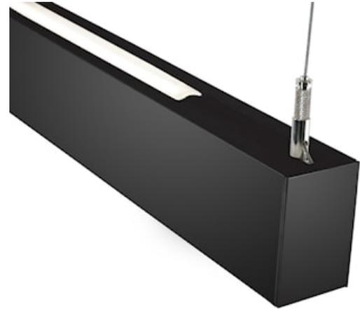
Luminaire LED linéaire, pour installation suspendue. Kit pré-câblé et pré-équipé avec embouts et câbles de suspension. Longueur 2400mm. Finition noire. Diffuseur prismatique. Eclairage direct/indirect (65/35%) adressable séparément via DALI. Flux 7700lm, efficacité lumineuse 133lm/W. Température de couleur : blanc neutre (4000K). IRC > 80 / SDCM < 3. Groupe de risque photobiologique GR0. IP20 / IK03. Durée de vie 92 500 heures (L80). Garantie 5 ans.
