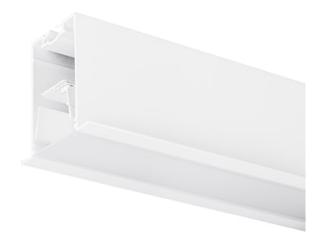
Luminaire LED linéaire, pour installation encastrée. Module avec bords pour la réalisation de lignes continues. Longueur 2400mm. Finition blanche. Diffuseur opale. Eclairage direct. Dimmable DALI. Flux 4600lm, efficacité lumineuse 128lm/W. Température de couleur : blanc chaud (3000K). IRC > 80 / SDCM < 3. Groupe de risque photobiologique GR0. IP20 / IK03. Durée de vie 92 500 heures (L80). Garantie 5 ans.
