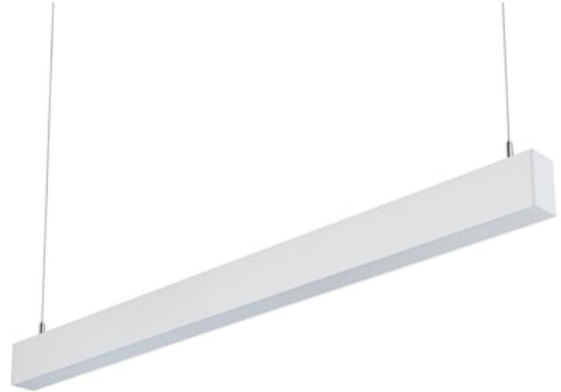
Luminaire LED linéaire, pour installation suspendue. Kit pré-câblé et pré-équipé avec embouts et câbles de suspension. Longueur 2400mm. Finition blanche. Diffuseur opale. Eclairage direct. Dimmable DALI. Flux 4600lm, efficacité lumineuse 128lm/W. Température de couleur : blanc chaud (3000K). IRC > 80 / SDCM < 3. Groupe de risque photobiologique GR0. IP20 / IK03. Durée de vie 92 500 heures (L80). Garantie 5 ans.
