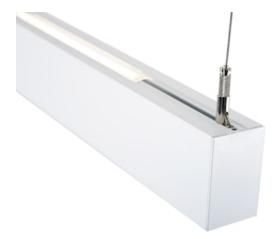
Luminaire LED linéaire, pour installation suspendue. Module pour la réalisation de lignes continues. Longueur 2400mm. Finition blanche. Diffuseur opale. Eclairage direct/indirect (65/35%) adressable séparément via DALI. Flux 7800lm, efficacité lumineuse 134lm/W. Température de couleur : blanc chaud (3000K). IRC > 80 / SDCM < 3. Groupe de risque photobiologique GR0. IP20 / IK03. Durée de vie 92 500 heures (L80). Garantie 5 ans.
