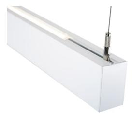
Luminaire LED linéaire, pour installation suspendue. Module pour la réalisation de lignes continues. Longueur 1200mm. Finition blanche. Diffuseur opale. Eclairage direct/indirect (65/35%) adressable séparément via DALI. Flux 3900lm, efficacité lumineuse 134lm/W. Température de couleur : blanc chaud (3000K). IRC > 80 / SDCM < 3. Groupe de risque photobiologique GR0. IP20 / IK03. Durée de vie 92 500 heures (L80). Garantie 5 ans.
