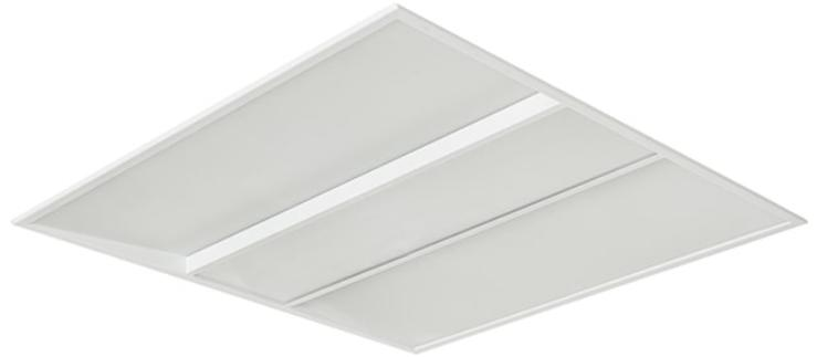
Luminaire LED encastré architectural avec optique micro-prismatique et distribution semi-directe de la lumière. UGR<19. Version haute efficacité (HE) : 140lm/W. Flux lumineux : 3300lm. Température de couleur blanc neutre (4000K). IRC80. Caisson fermé ( finition blanc RAL 9016) réduisant la pénétration de la poussière et améliorant le facteur de maintenance du luminaire (LMF). IP20, IK03. Dimensions : 595mm x 595mm x 92mm. Durée de vie 100 000 heures (L80). Garantie 5 ans
