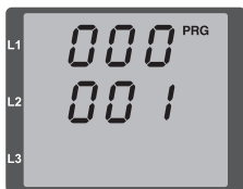
Fig. Mode de programmation de l'affichage de paramètres Les touches 1 et 2 permettent de modifier les différents paramètres (cf. page 32).
