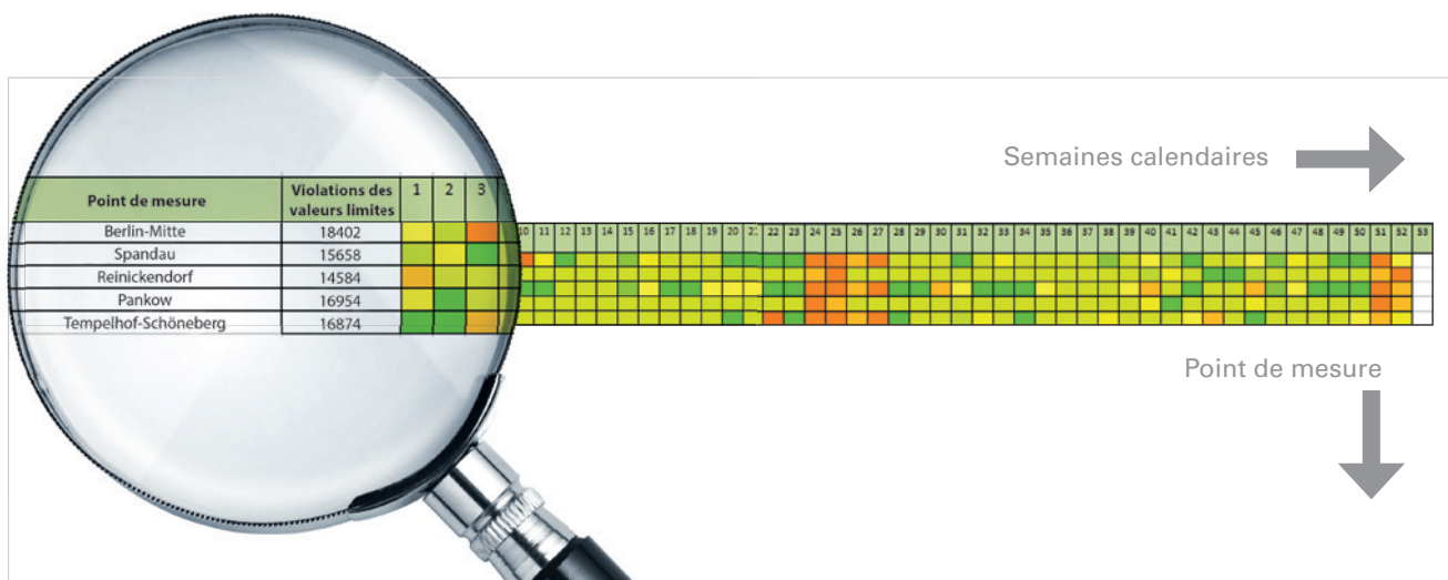
Fig. : Heatmap, c-a-d l'illustration en couleur (principe des feux de circulation) de la qualité de l'Énergie pour un point de mesure en particulier dans une semaine calendaire. Ce principe garantit un aperçu rapide de l'ensemble de la fourniture d'électricité.
