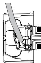
La connexion arrière limite la déformation du câble coaxial, évitant une rupture d'impédance et préserve donc les performances.
