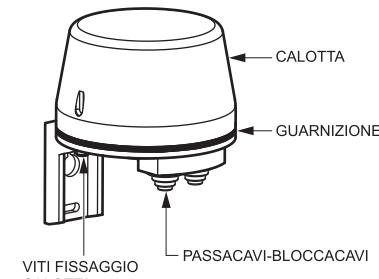
**4 - PROCEDURA DI INSTALLAZIONE****Installazione dell'interruttore crepuscolare**
