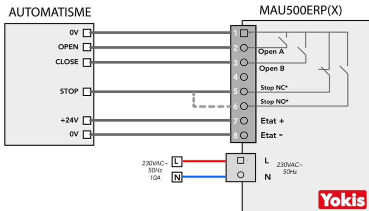
\* En fonction du mode de fonctionnement de l'automatisme à piloter, câbler le STOP de l'automatisme :
