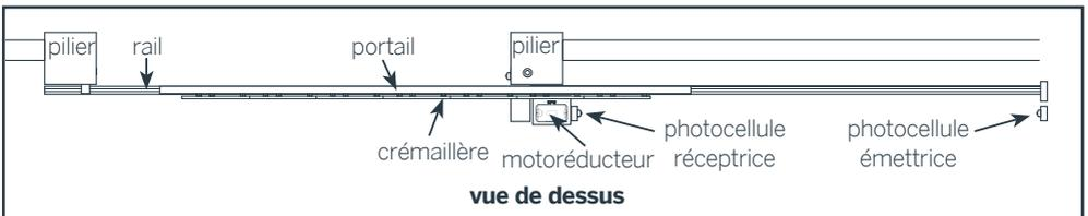
La coupure du faisceau des photocellules doit provoquer l'arrêt d'urgence du portail. Dans ce cas, la sortie normalement fermée de la photocellule réceptrice (RX) doit être connectée sur l'entrée **STOP** de la carte électronique.
