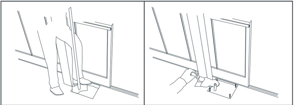
Les broches doivent correspondre au gabarit de pose fourni, attendez que le scellement soit bien sec avant de monter le moteur.
