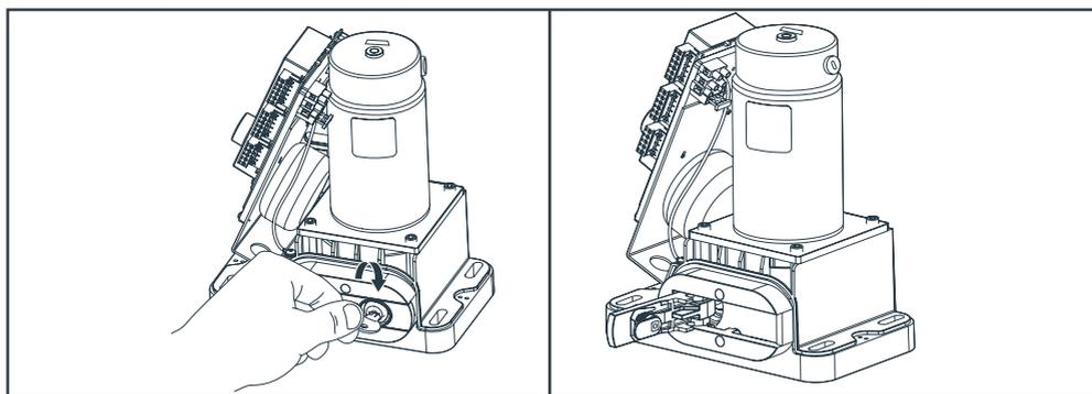
Fermez complètement le portail. Positionnez un premier élément de crémaillère sur la roue dentée de la motorisation. La partie du portail où doit être fixés les éléments de crémaillère doit être rigide
