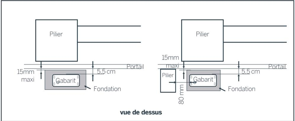
Le passage des câbles doit être conforme aux normes en vigueur (NFC 15-100). Soit le câble est à 80cm de profondeur avec grillage de signalisation rouge, soit le câble est passé dans un fourreau. Placez la gaine de passage de câble ainsi que les broches de fixation au sol comme indiqué sur le schéma ci-dessous avant de couler le béton :
