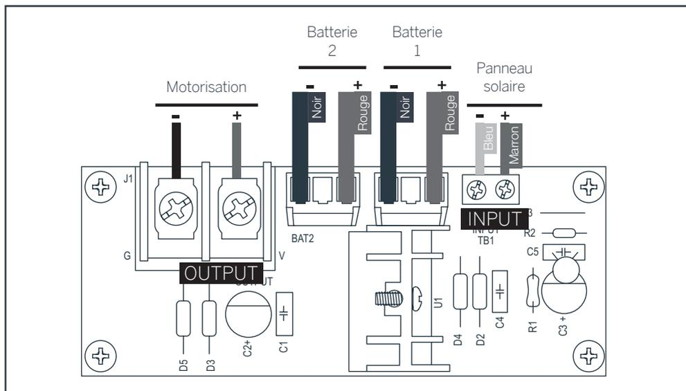
2. Connecter le panneau solaire au bornier vert « INPUT ». Respecter la polarité en suivant scrupuleusement le schéma de branchement.
