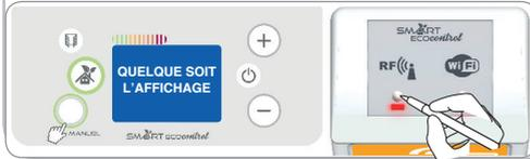
Appuyer 6 secondes sur le bouton "RF" du module SERVEUR jusqu'à ce que le voyant lumineux passe au rouge fixe.
