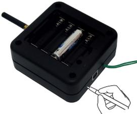
3- Placer une seule pile dans n'importe lequel des quatre emplacements tout en maintenant pendant 6" l'appui sur le bouton.
