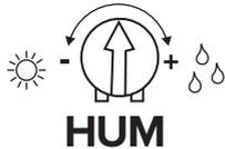
L'extracteur ne se met pas en marche tant qu'un niveau de condensation plus élevé n'est pas atteint (dans le sens des aiguilles d'une montre)
