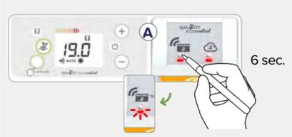
**7** SUR L'APPAREIL SMART ECOCONTROL® SUIVANT, INSÉRER UN MODULE CHAUFFAGE (C) DANS SON EMBLEMMENT. (voir notice d'utilisation de l'appareil) Le voyant lumineux clignote au rouge. Attendre que celui-ci ne clignote plus.
