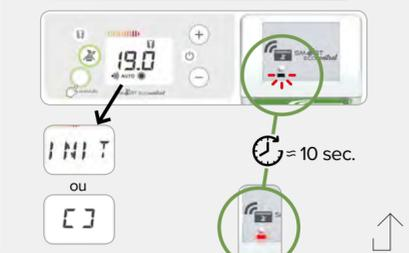
**8** Appuyer 6 secondes sur le bouton RF (A) jusqu'à ce que le voyant clignote lentement au rouge. Le module est apparié au bout de quelques secondes lorsque le voyant s'éclaire à l'orange.
