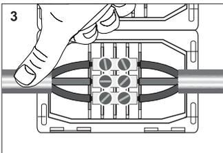
Fig. 3 Placer le connecteur au centre de la boîte de raccordement. Immerger-le dans le gel.
