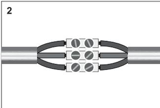
Fig. 2 Mettre les conducteurs dans le connecteur. Serrer les vis du connecteur.
