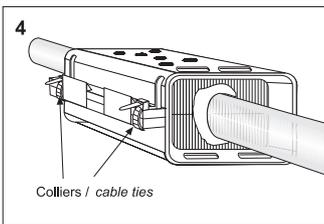
Fig. 4 Fermer la boîte de raccordement tout en contrôlant que le gel s'échappe au niveau des câbles. Maintenir la fermeture de la boîte de raccordement à l'aide des colliers. (Norme IEC 364).
