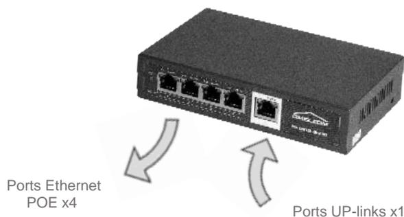
\*POE : Power Over Ethernet. Alimentation par le câble multipaire en plus de la connexion réseau.
